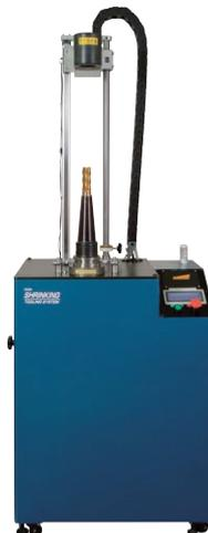
各ホルダ(標準)の加熱時間および、冷却時間はシーケンサーにて、設定されています。特殊ホルダについての設定も対応可能。
