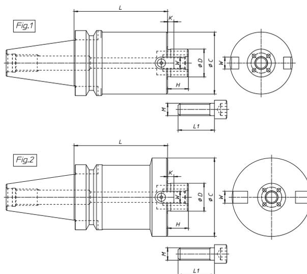
※SBTタイプはBT2面拘束主軸対応ツールリングです。(BTタイプも対応致します)
